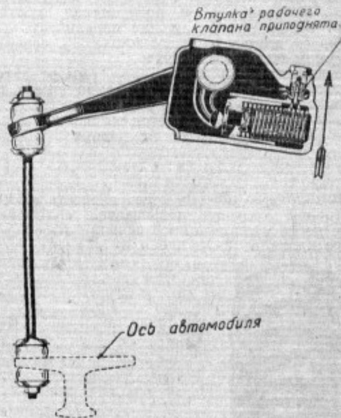
Рис. 5. Действие рабочего клапана при резких перемещениях рамы вверх. Тарелки клапана подняты. Жидкость проходит через кольцевую щель
